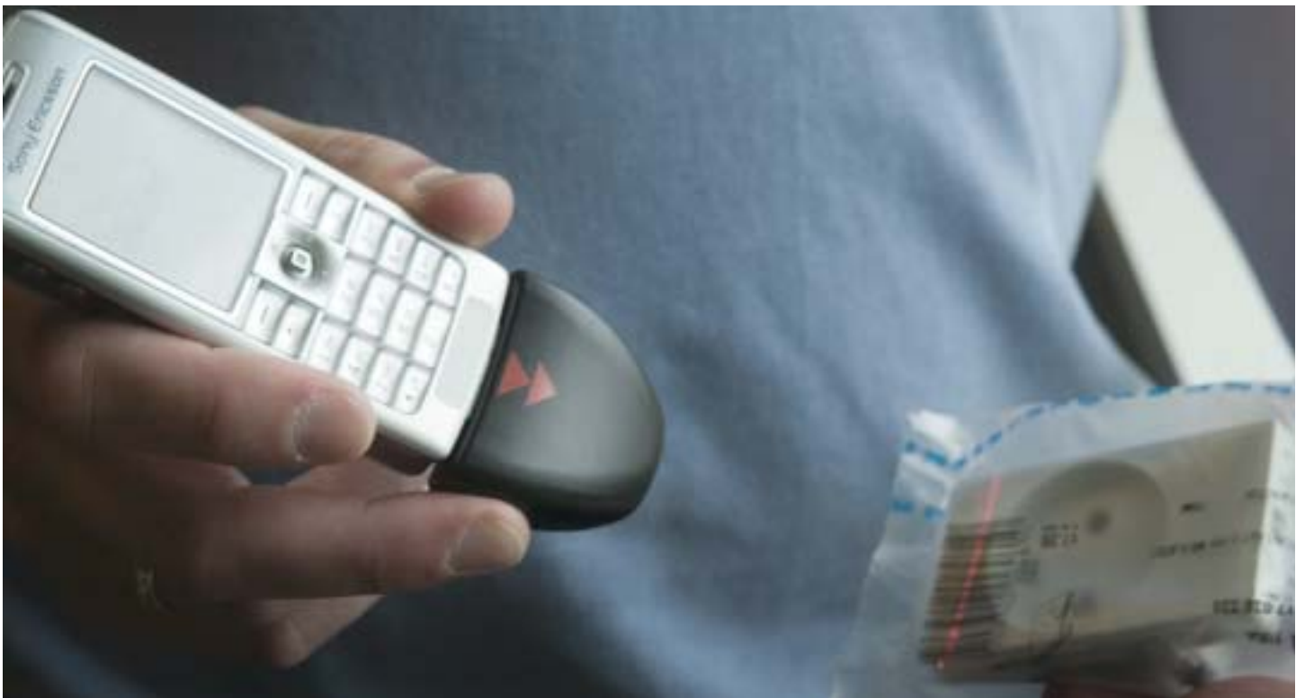
Ved hjælp af en scanner og stregkoder registreres tids- og materialeforbruget på stedet.
